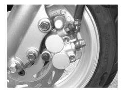
NOTE: PLEASE BE SURE TO PUT THE COVER BACK AND FASTEN. IF THE BRAKE AREA IS WET GETTING WATER), THE BRAKE WILL BE OUT OF ORDER AND DANGEROUS.
